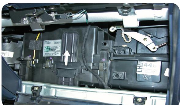
**IT** Rimuovere la copertura della camera filtrante
