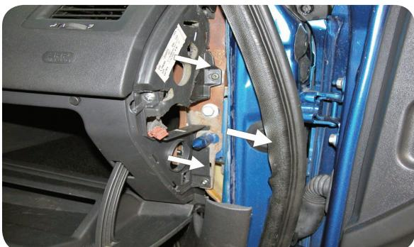
**IT** Rimuovere la guarnizione in gomma. Allentare la vite e rimuovere il pannello tappezzato
