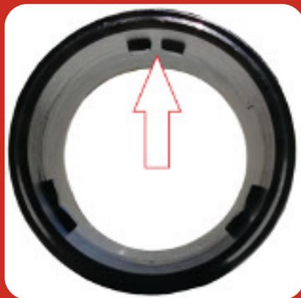
Der Adapterring besitzt drei Verriegelungsnasen auf der Innenseite des Ringes. Eine Verriegelungsnase hat eine Positionsnut. Auf dem Stecker befindet sich eine Verriegelungsführung. Den Ring so aufsetzen, dass die Positionsnut des Ringes in die Führung des Steckers mit der Nase passt und um 90 ° im Uhrzeigersinn verdrehen.
