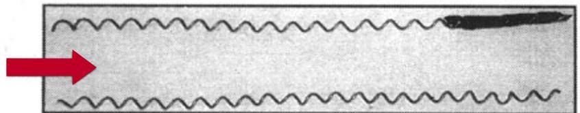
Wenn Fremdkörper sich an den Turbolatoren ansammeln, wird der Korrosionsprozess für kurze Zeit unterbrochen und durch die Verstopfung baut sich ein erhöhter Druck auf, wodurch sich unter Hochdruck ein sehr feiner Strahl Kühflüssigkeit entwickelt, der in den U-Bögen Löcher verursacht.
