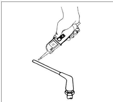
**Détection d'augmentation de tension**
