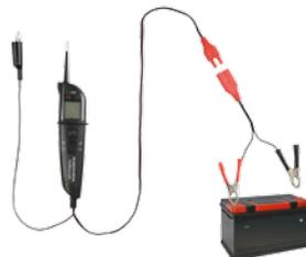
**Prüfung der Polarität**
