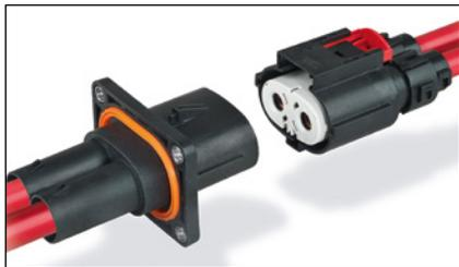
Diese Steckverbindung mit Rundlamellen in versetzter Anordnung besitzt außerordentlich viele Kontaktpunkte mit hoher Kontaktkraft. Dadurch wird eine hohe Schlag-, Stoß- und Vibrationsfestigkeit erreicht.
