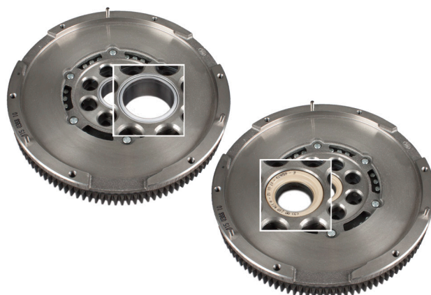
Fig. 1: Comparație între DMF LuK 415 0388 10 cu lagăre de alunecare (stânga) și rulmenții cu bile (dreapta)
