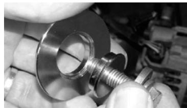
**2. Druckscheibe in die Druckplatte einsetzen**
