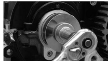
**4. Neuen Simmerring durch Anziehen der Zentralschraube einpressen**
