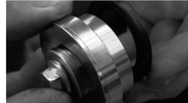
**3. Passende Einpressbuchse auswählen**
