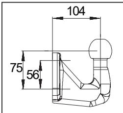
**NL** Bij gebruik van deze trekhaak met een 4-gats kogel dient men een UNECE R55-goedgekeurde kogel te monteren welke voldoet aan een lengte van 104mm, een hoogte van 75mm en aan de minimale D-waarde v.lgs. pagina 2. Bij montage van een 4-gats kogel dient men een uitbreidingskit te bestellen: artikelnr.: 019-554
