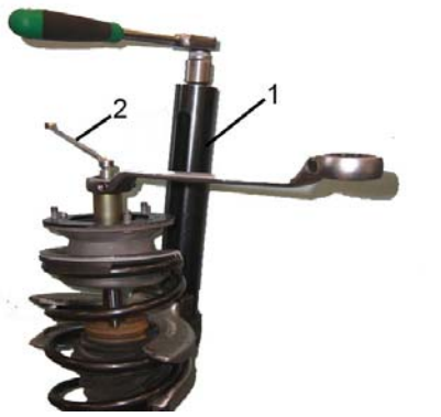
Fig. 6 1 Federspanner / Spring tensioner / Tendeur de ressort / Tensor de muelle 2 Spezialwerkzeug / Special tool / Outil spécial / Herramienta especial
