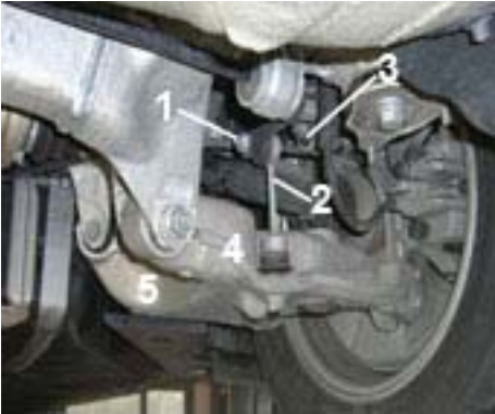
Fig. 7 1 Leuchtweitenregulierung / Headlight leveling control / / Tige de réglage de la portée des phares / Regulación de los faros 2 Koppelstange / Piston rod / Bielle de connexion / Barra de acoplamiento 3 Untere Federbeinbefestigung / Lower suspension strut fastening / Fixation inférieure de la jambe de force / Fijación inferior del amortiguador 4. Querlenker hinten / Track control arm rear / Bras transversal arrière / Barra transversal trasera 5 Zugstrebe / Tension strut / Tirant / Tirante diagonal
