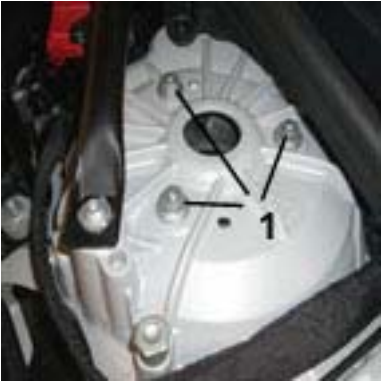
Fig. 4 1 Befestigungsmuttern / Fastening screws / Ecrous de fixation / Tuercas de sujeción
