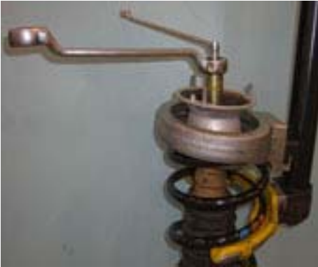
Fig. 6 Spezialwerkzeug / Special tool / Outil spécial / Herramienta especial Kolbenstangenmutter / Piston rod nut / Ecrou de la tige de piston / Tuerca del eje del amortiguador
