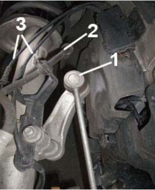
Fig. 2 1 Koppelstange / Coupling rod / Bielle de connexion / Varillaje regulador de los faros 2 Bremsschlauch / Brake hose / Flexible de frein / Manguito del freno 3 Sensorleitungen / Sensor cables / Câbles de capteur / Conductos de los sensores
