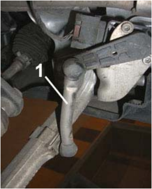
Fig. 1 1 Leuchtweiten Regelgestänge / Headlight leveling control arm / Tige de réglage de la portée des phares / Varillaje regulador de los faros
