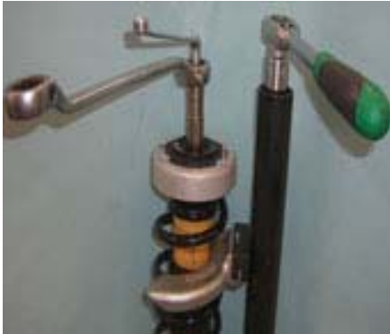
Fig. 9 Spezialwerkzeug / Special tool / Outil special / Herramienta especial Kolbenstangenmutter / Piston rod nut / Ecrou de la tige de piston / Tuerca del eje del amortiguador
