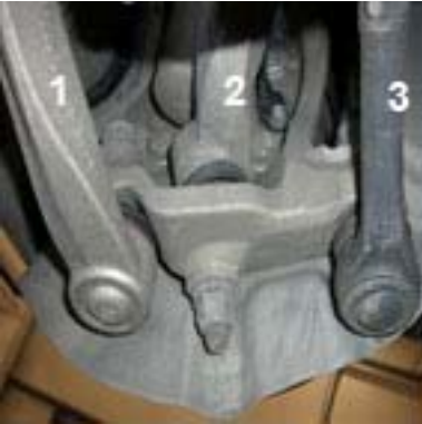
Fig. 3 1 Querlenker / Track control arm / Bras transversal / Brazo de dirección transversal 2 Zugstrebe / Tension strut / Barre de force / Tirante diagonal 3 Spurstange / Tie rod / Barre d'accouplement / Barra de dirección
