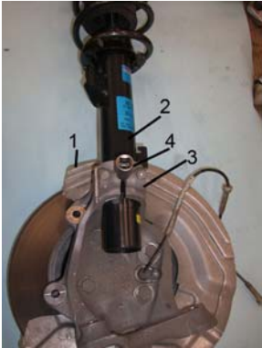
Fig. 5 1 Radträger / Wheel carrier / Support de roue / Rótula 2 Federbein / Suspension strut / Jambe de force / Columna de suspensión 3 Befestigungsschraube / Fastening screw / Vis de fixation / Tornillo de sujeción 4 Spezial Spreizer / Special expander tool / Broche extensible spéciale / Distanciador especial
