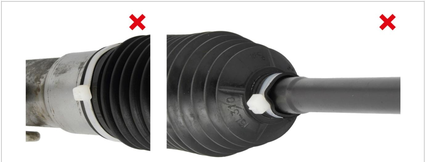
Abb. 8: Bypass: Mangelhafte Abdichtung mit Kabelbindern
