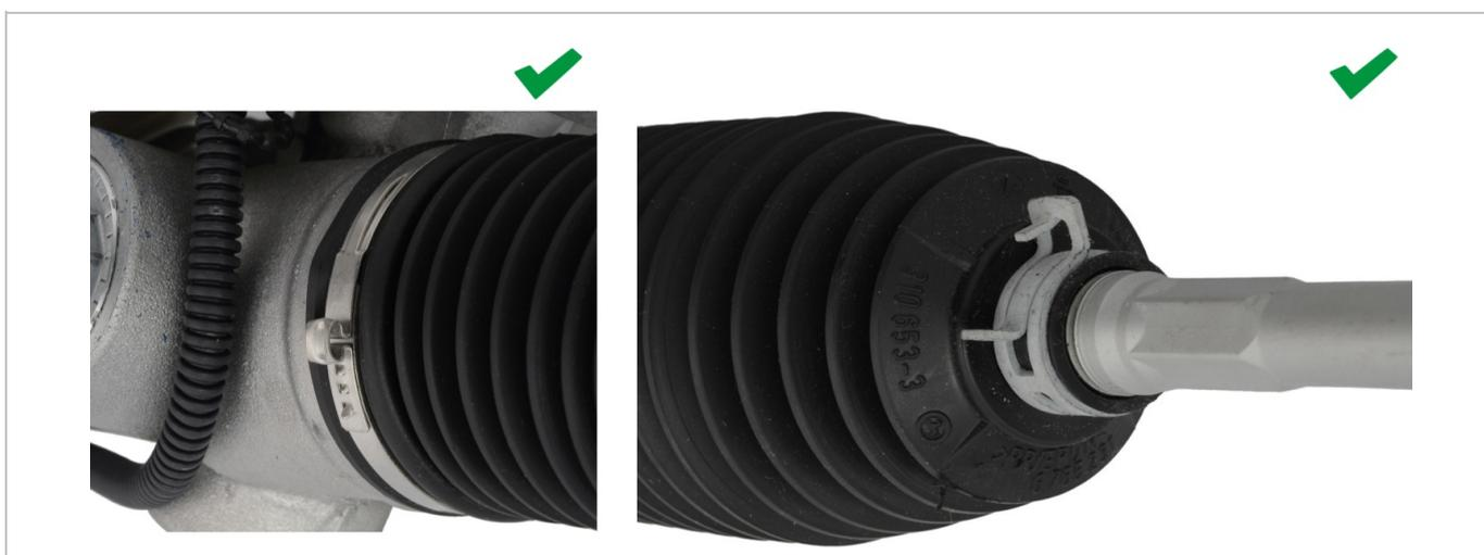
Abb. 6: Kein Bypass: korrekte Abdichtung mit Metallschellen
