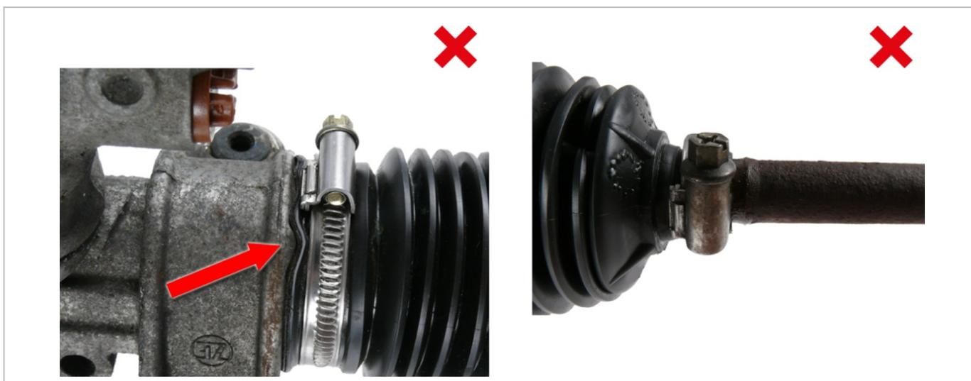
Abb. 7: Bypass: Mangelhafte Abdichtung mit Schlauchschellen
