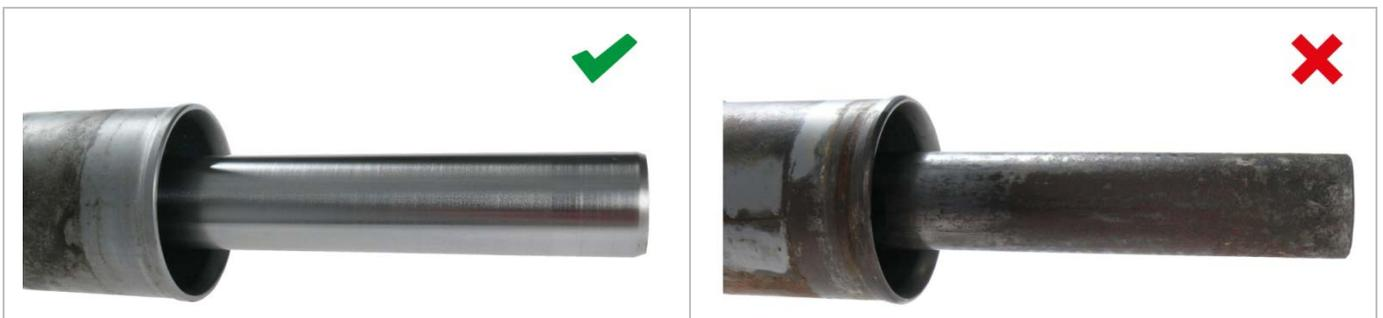
Abb. 3: Zahnstange ohne Korrosion
