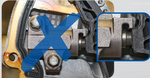
**DE** Den Kettenspanner SWAG 40 10 0006 ansetzen, dann beide Schrauben nur leicht anziehen. Anschließend den Kettenspanner gegen den Uhrzeigersinn „drehen“, festhalten und die Schrauben mit 8 Nm festziehen. Die Führung der Gleitschiene darf die Arretierungsnase des Spanners nicht berühren (siehe Pfeil). Nur in diesem Fall kann der Freilauf des Druckkolbens und der Gleitschiene gewährleistet werden.
