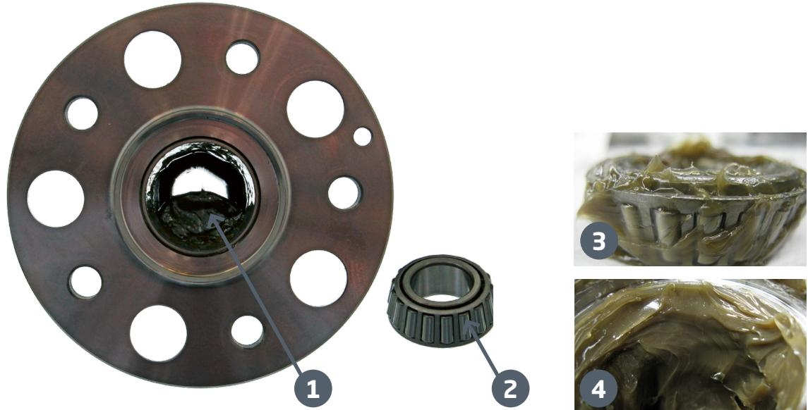
**DE** Bei der Montage dieser Radnabe auf den Achsschenkelzapfen wird das in die Radnabe eingefüllte Fett (1) herausgedrückt. Das äußere Kegelrollenlager (2) und die Lagerschale müssen vor der Montage des Lagers mit dem ausgedrückten Fett großzügig gefettet werden (3 und 4).
